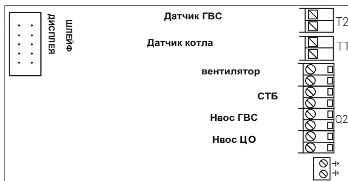
Схема подключения TIS-tronic 210
